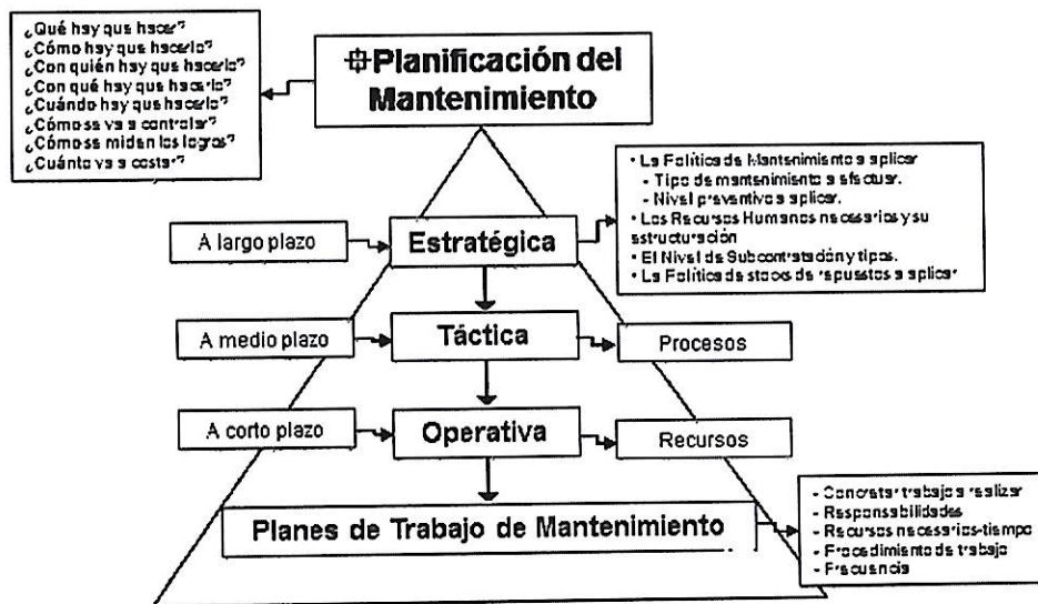
Ilustración 1 Planificación del Mantenimiento
